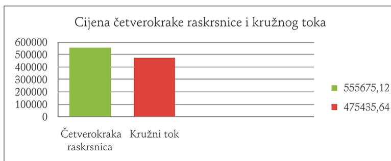
**Slika 1.** Cijene četverokrake raskrsnice i kružnog toka
